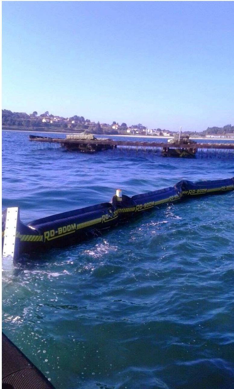
Fig 3: Dirfter enganchado en la barrera para posicionar la barrera y su forma, a modo de validación del modelo de barreras.
